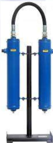
Фильтрационный модуль предназначен для тонкой очистки сжатого воздуха и различных газов, от аэрозолей масла и влаги, а также от твердых частиц размером менее 3 мкм. Обеспечиваемое остаточное содержание аэрозоля масла - менее 5 мг/м<sup>3</sup>. Используется в системах пневмоуправления и автоматики, пневмоприводе устройств и инструмента для окраски поверхностей распылением.
