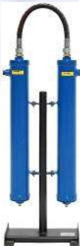
Фильтрационный модуль предназначен для тонкой очистки сжатого воздуха и различных газов от аэрозолей масла и влаги, а также от твердых частиц размером более 3 мкм. Обеспечиваемое остаточное содержание аэрозоля масла - менее 5 мг/м<sup>3</sup>. Используется в системах пневмоуправления и автоматики, пневмоприводе устройств и инструмента для окраски поверхностей распылением.
