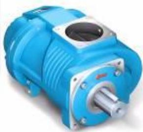
**Винтовой блок EVO15** производится компанией Rotorcomp (Германия) и является основой винтового компрессора. Визуально он представляет собой чугунный корпус, внутри которого, на подшипниках размещены два ротора, сжимающие воздух.
