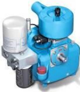
**Винтовой блок EVO3-NK** производится компанией Rotorcomp (Германия) и является основой винтового компрессора. Визуально он представляет собой чугунный корпус, внутри которого, на подшипниках размещены два ротора, сжимающие воздух.
