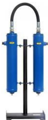
Фильтрационный модуль предназначен для тонкой очистки сжатого воздуха и различных газов от аэрозолей, масла и влаги, а также от твердых частиц размером более 10 мкм. Обеспечиваемое остаточное содержание аэрозоля масла - менее 16 мг/м<sup>3</sup>. Используется в системах пневмоуправления и автоматики, пневмоприводе устройств и инструмента для окраски поверхностей распылением.
