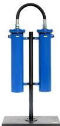
Фильтрационный модуль предназначен для тонкой очистки сжатого воздуха и различных газов, от аэрозолей масла и влаги, а также от твердых частиц размером более 10 мкм. Обеспечиваемое остаточное содержание аэрозоля масла - менее 16 мг/м<sup>3</sup>. Используется в системах пневмоуправления и автоматике, пневмоприводе устройств и инструмента для окраски поверхностей распылением.
